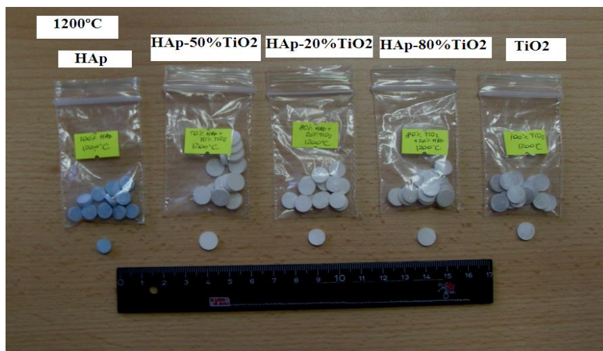
3.3. attēls. Paraugi pēc termiskās apstrādes 1200 °C
