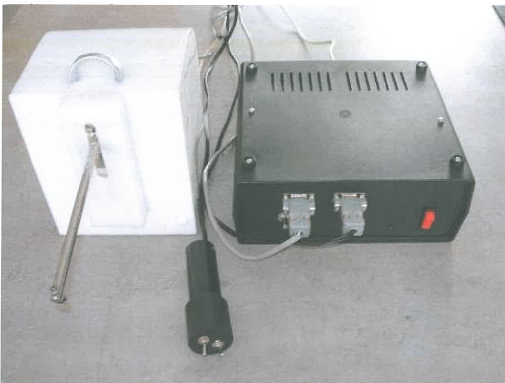
28.attēls. Slodzes testa ātrums un virziens tika kontrolēts ar speciāla slēdža palīdzību
