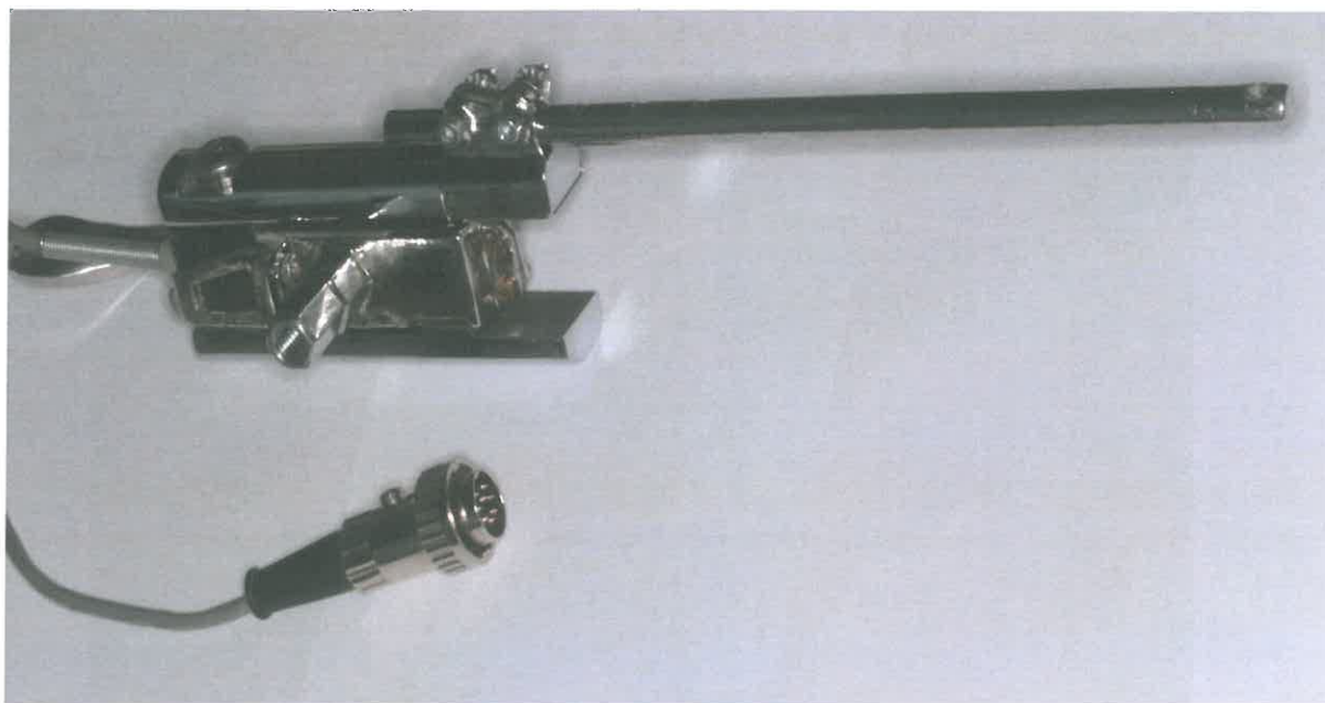
8.attēls. ADInstruments datorizēts spiedienjūtīgs mērinstruments
