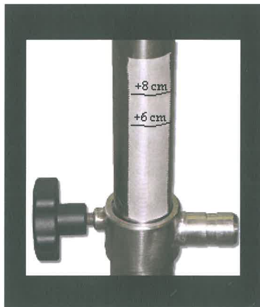
22. Attēls. Rokas paliktņa augstuma regulēšana +6 vai +8 cm pozīcijai
