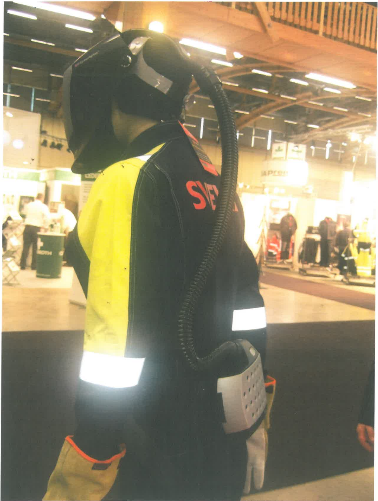
3. attēls. Metināšanas maska ar gaisa filtru, kas nodrošina tīra gaisa padevi maskas iekšpusē.
