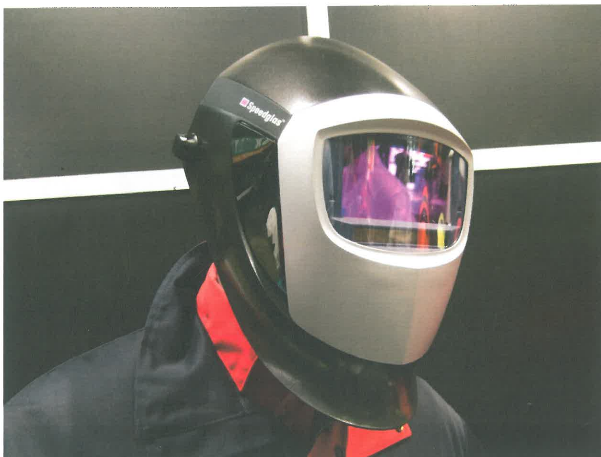
1. attēls. Metināšanas maska ar automātisku redzes lauka aptumšošanas (hameleons).
