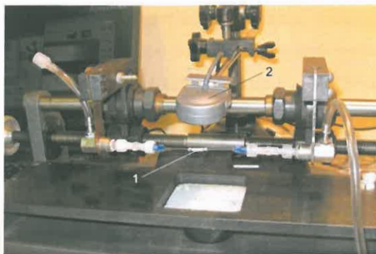
1.3.att. Sloģošanas stends ar optisko kameru: 1 – paraugs, 2 – TV kamera
