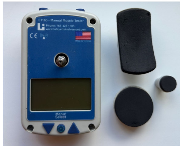
2. att.: Rokās turamais dinamometrs "Lafayette Instrument" (Lafayette Instrument Company, Sagamore Parkway North, USA) (att. no personīgā arhīva)
